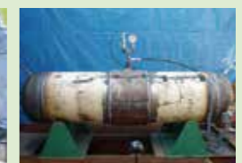
スリーブ溶接部外観
