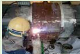
シーム溶接(ティグ+被覆アーク溶接)
