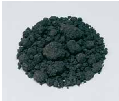
安定化処理後の飛灰
